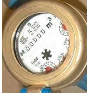
Der Wasserzähler mit dem Anlaufstern: Wenn er sich dreht, ist das ein erstes Anzeichen für verdeckten Wasserverbrauch
