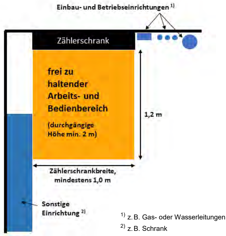
Abbildung 3: Arbeits- und Bedienbereich vor dem Zählerschrank
