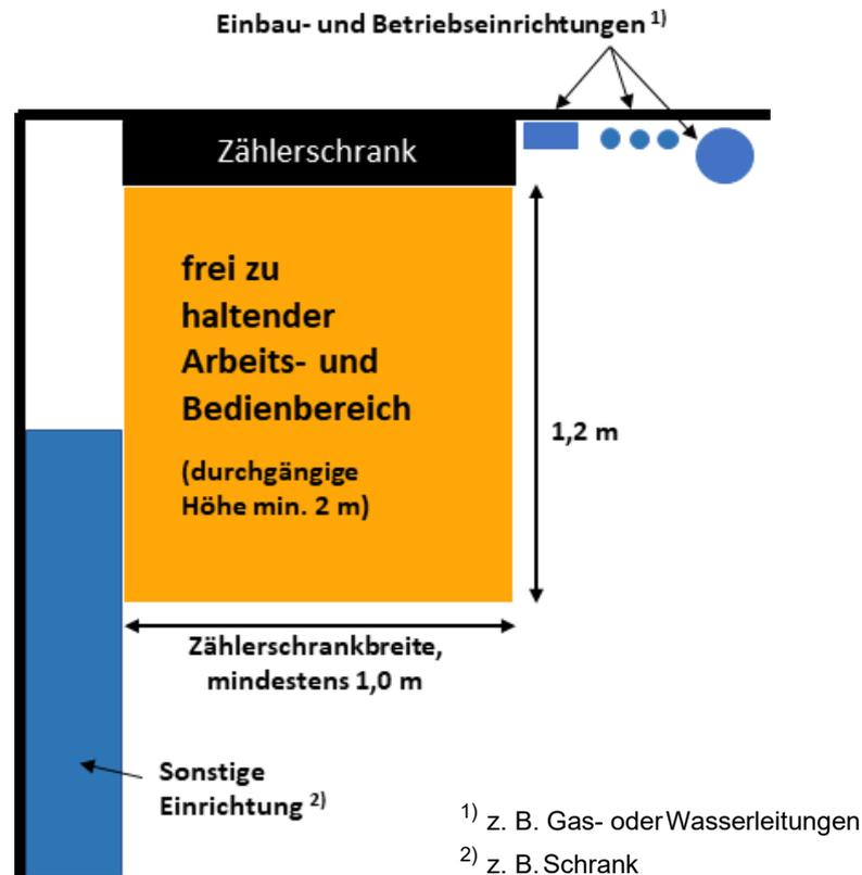
Abbildung 3: Arbeits- und Bedienbereich vor dem Zählerschrank
